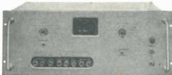
Fig. 3b - Il Dymec 2410 A è un convertitore c.a./ \Omega che può essere usato con il voltmetro 2401 A per la misura di tensioni alternate e di resistenze.
